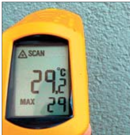
6.6 Oberflächentemperatur gleiche VAWD (Y=25) am 18.08.08 um 16.30 h am Schatten bei 29°C .
